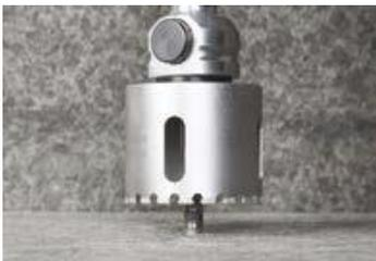
4. Wurde einige Millimeter mit der Lochsäge in das Material gebohrt, kann der Zentrierbohrer entfernt werden. Dies erhöht die Lebensdauer des Bohrers
