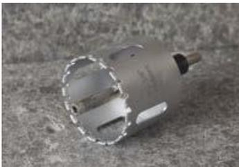
3. Lochsäge mit Zentrierbohrer in das vorgebohrte Führungsloch einsetzen
