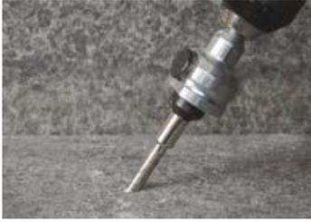
2. Zentrierbohrer aus Aufnahme entfernen, in die Lochsäge einsetzen
